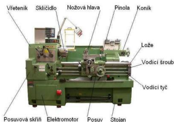
Obr. 1 - univerzální hrotový soustruh
