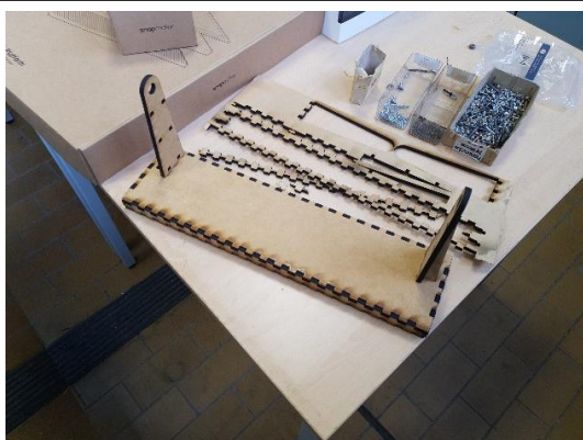
Obr. 10: Složená konstrukce ramene
