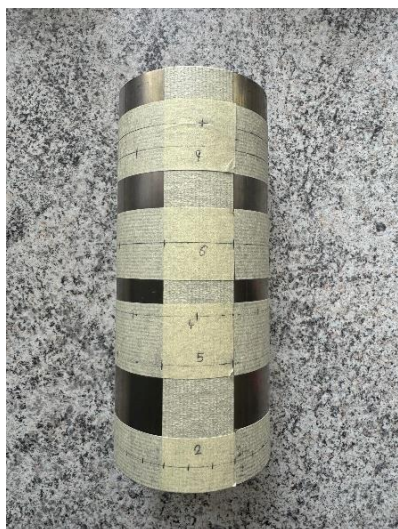
Obrázek 14 – Označení děr pro vrtání do plamence
