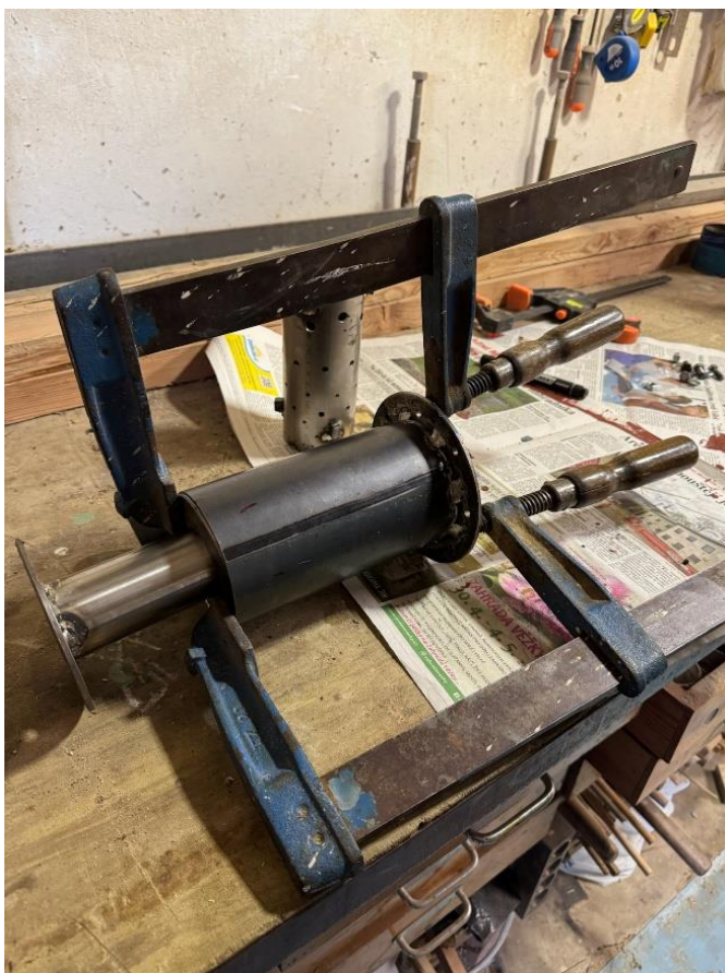
Obrázek 19 – Lisování vnější spalovací komory a přívodu do turba
