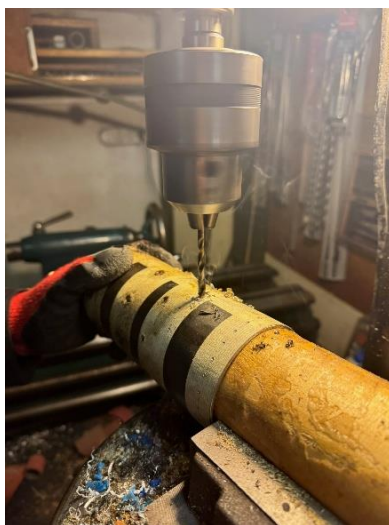
Obrázek 15 – Vrtání děr plamence
