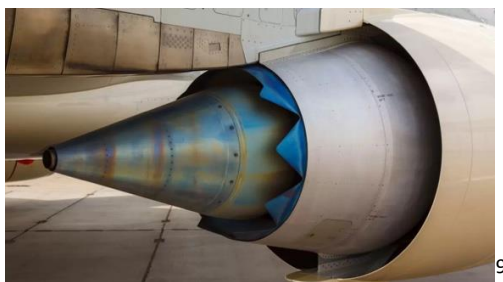
Obrázek 7 - Výfuk motoru na komerčním letadle
