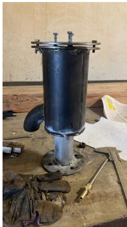
Obrázek 18 – zhotovená spalovací komora
