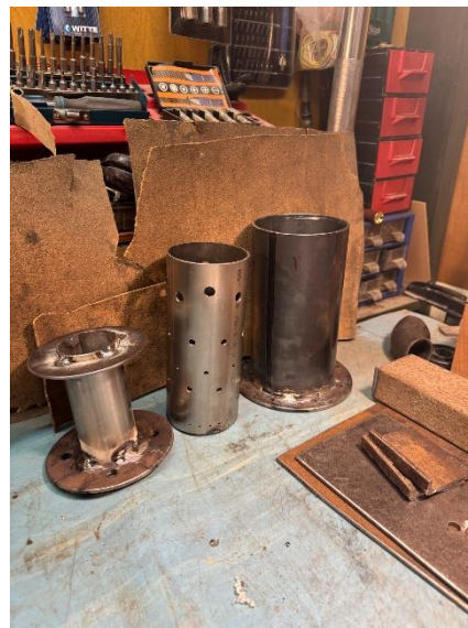
Obrázek 18 – Části spalovací komory
