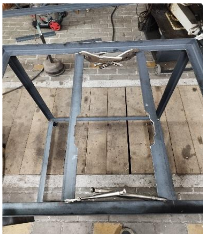
Obrázek 8 zavěšení kovářské vložky
