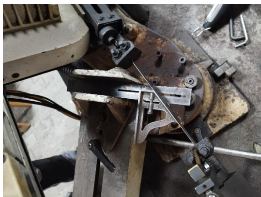
Obrázek 2 pásová pila pod úhlem 45°
