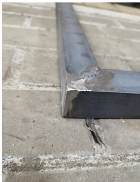
Obrázek 5 zabroušený svar horního rámu
