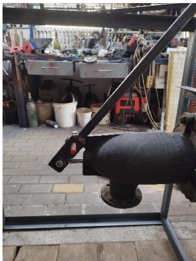
Obrázek 7 ovládací páka kovářské vložky
