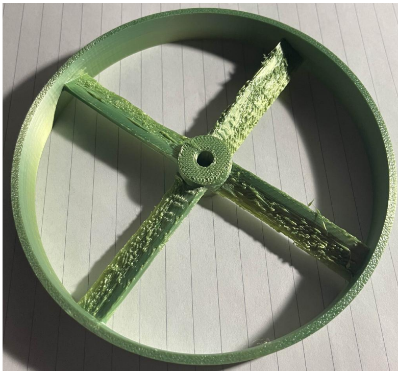
Obrázek 1: Vrtule s vadnou strukturou povrchu lopatek
