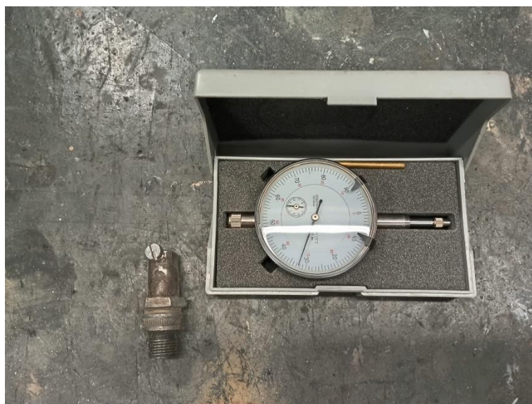
Obrázek 14 úchylkoměr s přípravkem pro montáž místo svíčky
