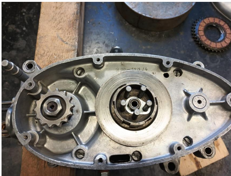
Obrázek 11 Montáž pevné lamely
