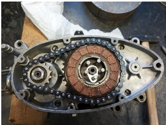
Obrázek 13 Montáž lamel s primárním řetězem
