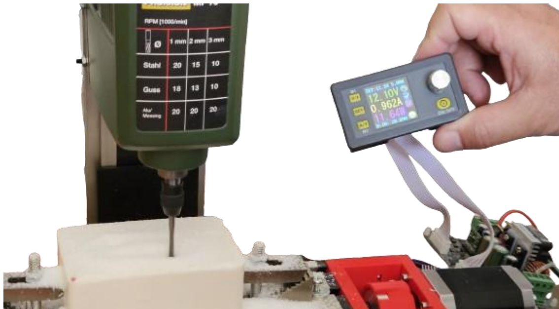
Obrázek 25 – frézování kapsy s displejem zdroje
