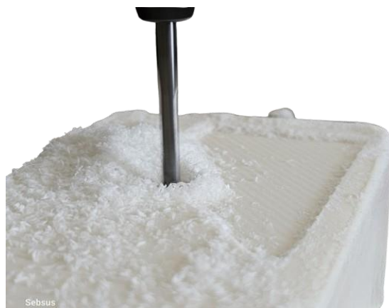
Obrázek 23 – frézování plochy (face)
