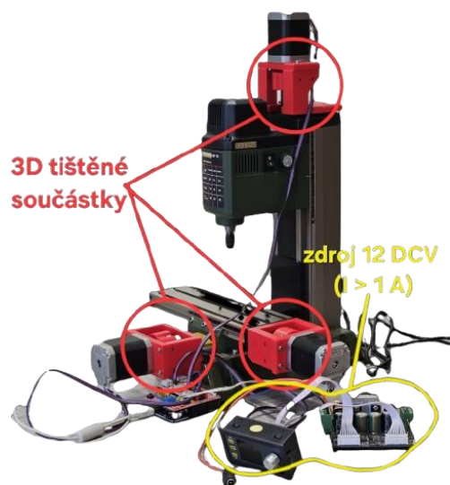
Obrázek 14 – přestavěná frézka s popisky
