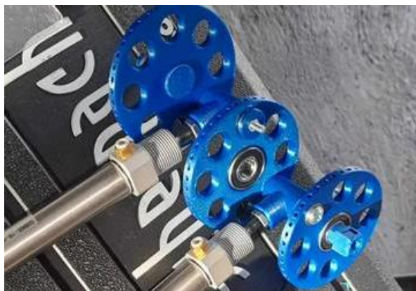
Obrázek 6 : Klikový mechanismus modelu 1
