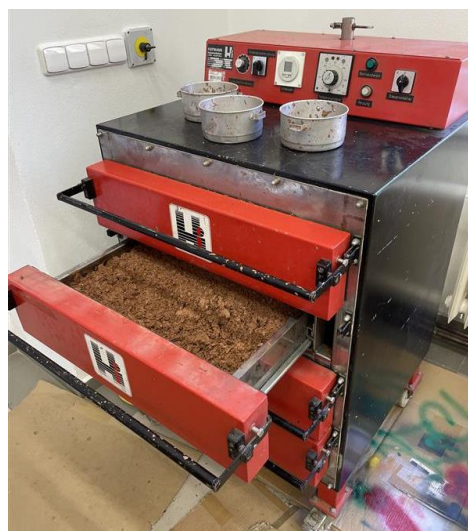
Obrázek 30 Pec na sirnou Clay plastelínu
