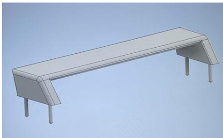
Obrázek 46 Konstrukce spoileru v Inventoru
