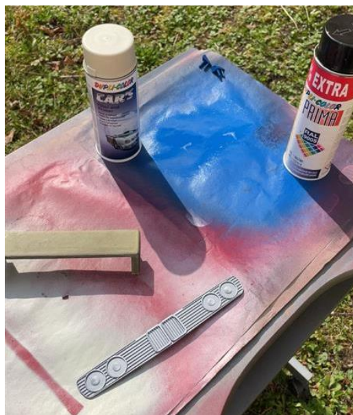
Obrázek 51 Lakování prvků z 3D tisku
