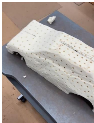
Obrázek 24 Připravený základ na nanášení Claye
