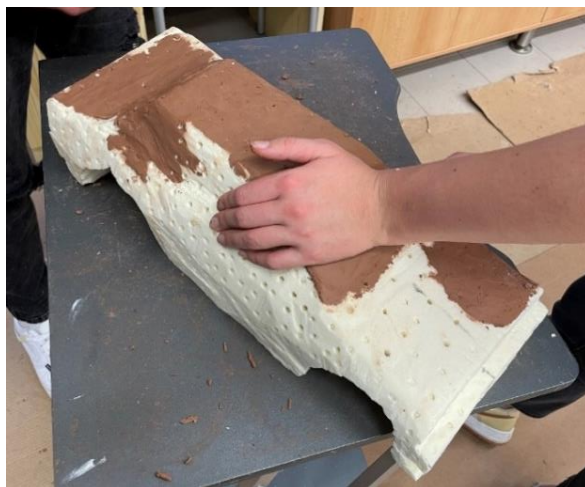
Obrázek 28 První nanášení Clay plastelíny
