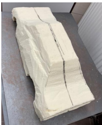
Obrázek 25 Ořezaný základ modelu
