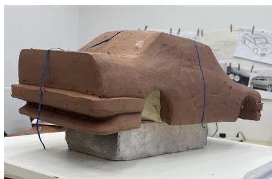
Obrázek 32 Tejpky značící střed modelu
