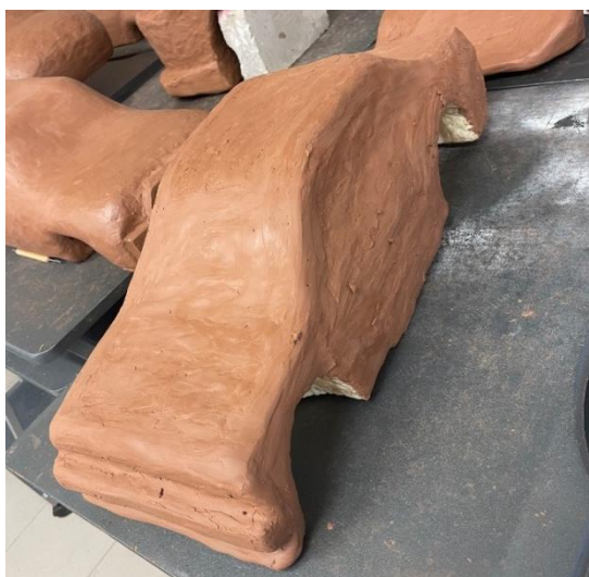
Obrázek 29 První vrstva Claye na modelu
