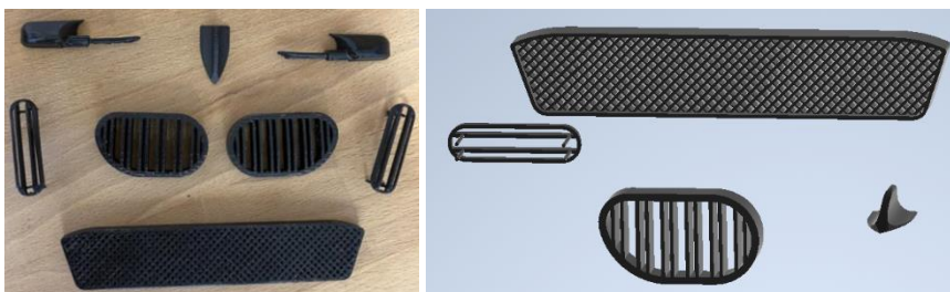
Obrázek 21 Vytisknuté ostatní komponenty a díly v Inventoru
