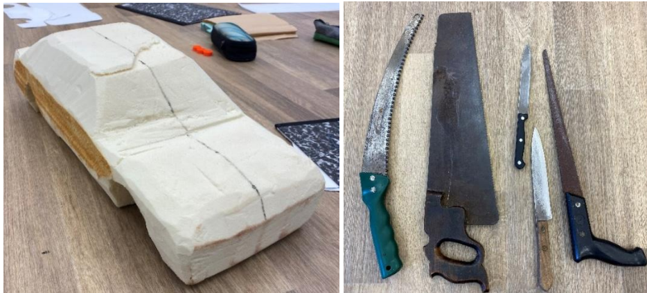
Obrázek 16 Základ modelu a nástroje na polystyren
