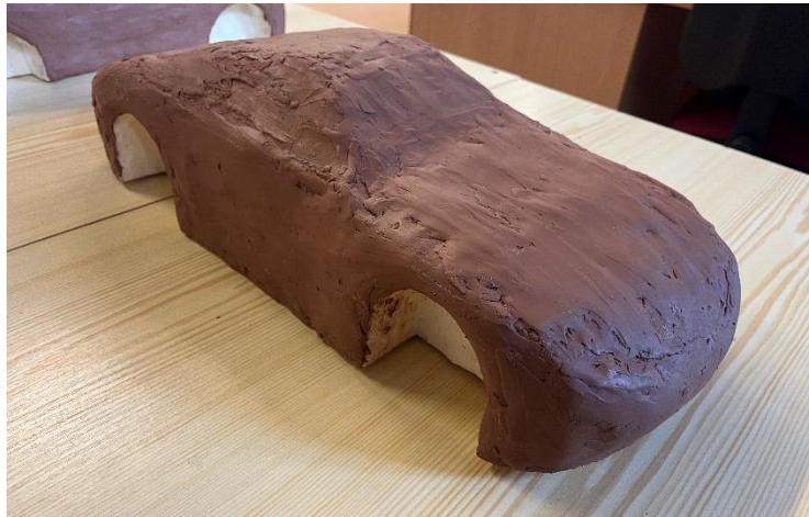
Obrázek 21 První vrstva Clay modelíny
