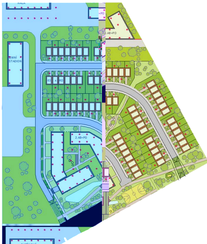
Obr. č. 9: Samostatné vrtné pole
