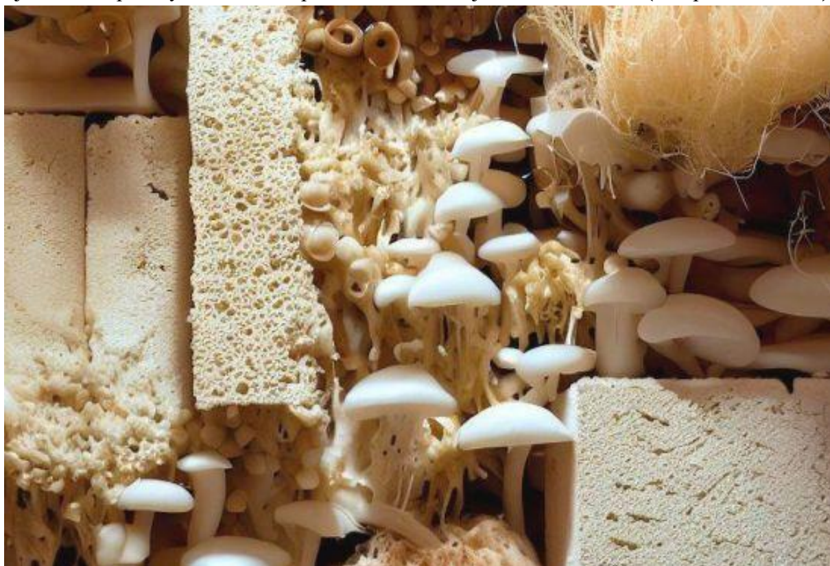
Obr. 2 Mykokompozit z podhoubí reishi
