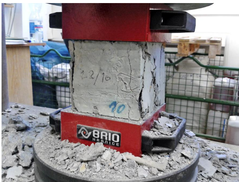
Obr. 3 Ukázka pevnosti samoléčivého betonu
