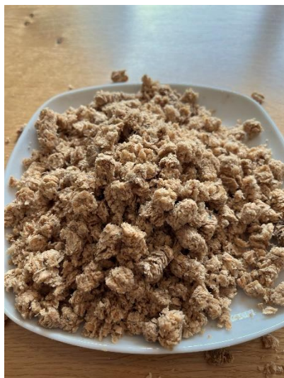
Obrázek 6 Pelety působením vody zvětšují svůj objem a rozpadají se [10]
