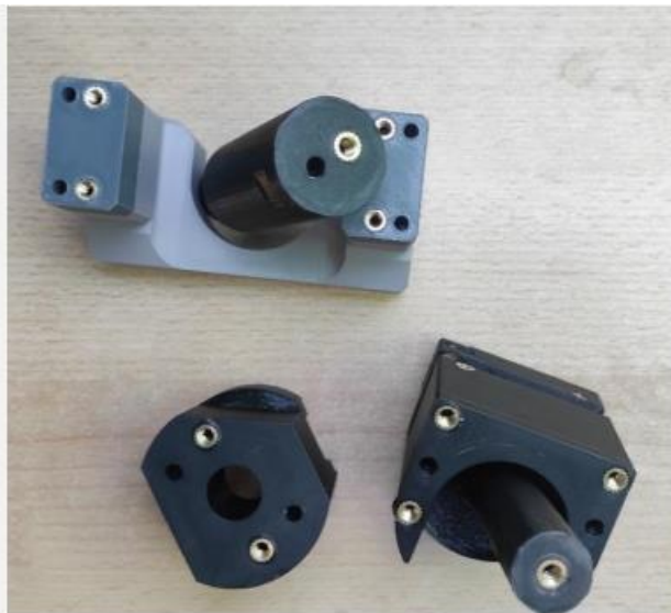
Obr. 19 – Modely se vtavenými závitovými vložkami
