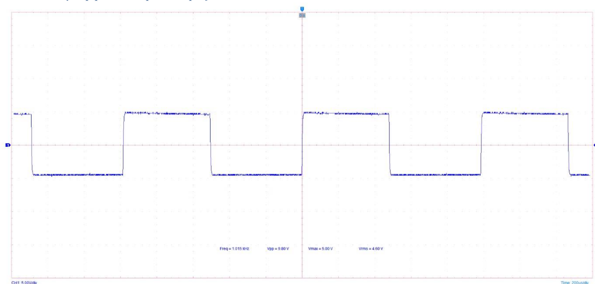
Obr. č. 121 Výstup obdélníkového průběhu při frekvenci 1 kHz s pracovním cyklem 50 %
