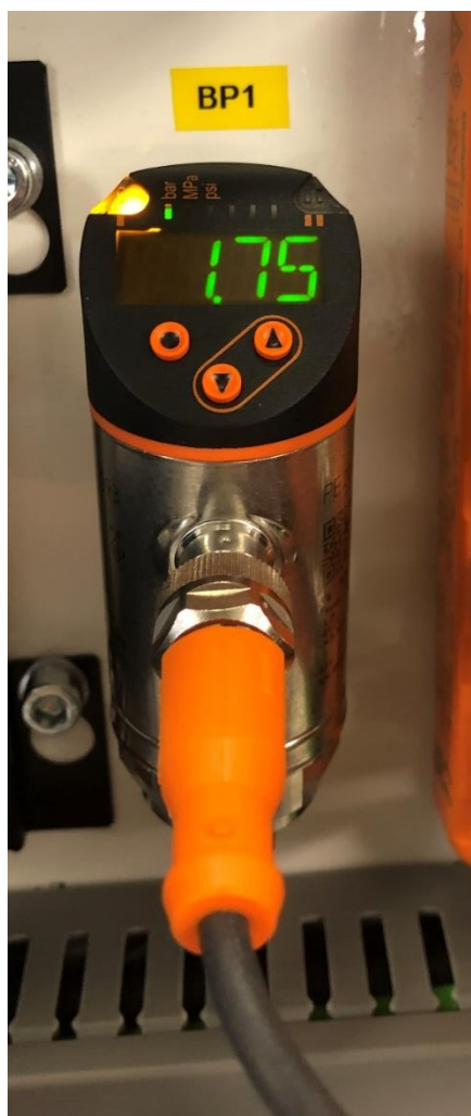
Obrázek 19 - Čidlo tlaku vzduchu; Zdroj: Autor
