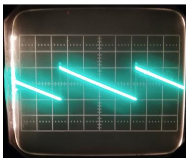
Obr. 3: Ukázka výstupu pilového průběhu
