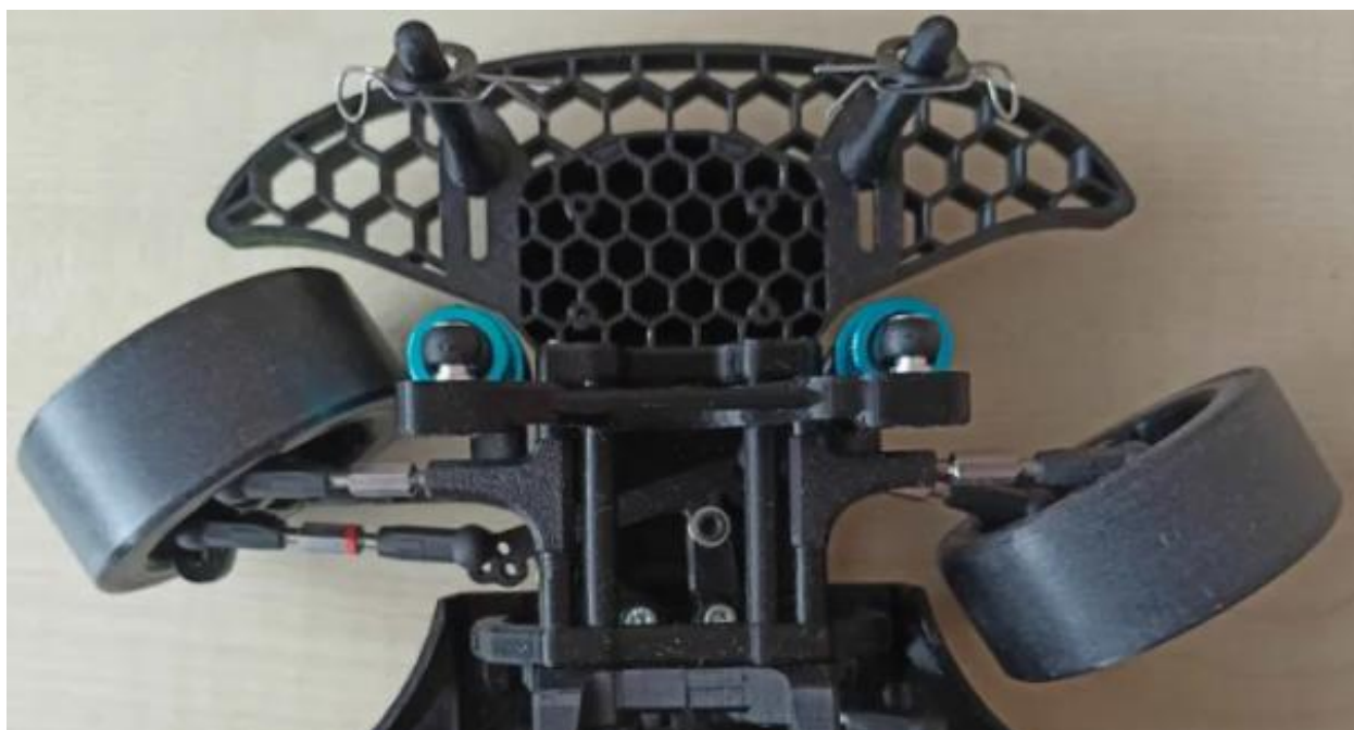
Obr. 58. Ukázka maximálního zatočení kol (lze porovnat s obrázkem č.25 na straně 23).
