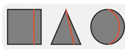
Obrázek 1: Pohled z kamery: Tvar do laseru se mění podle skenovaného objektu
