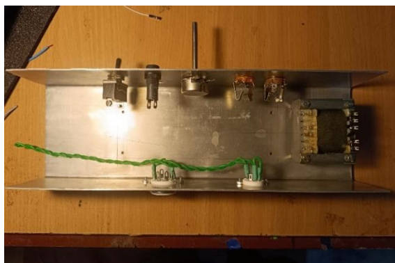
Obrázek 7 - šasi zesilovače - pohled dovnitř
