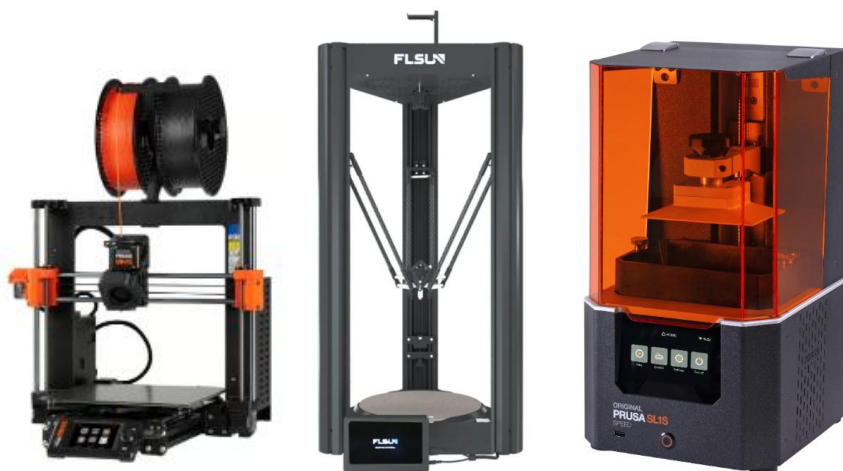
Obr. 8 3D tiskárny (řazeny z leva) - kartézská, delta, MSLA [18, 19, 18]
