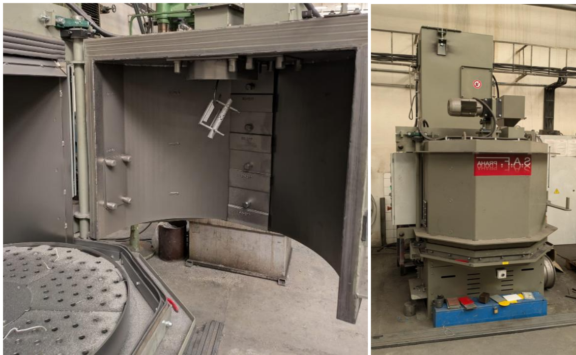
Obr. 36 Odlitek 1 zavěšený v brokovém tryskači a použitý brokový tryskač
