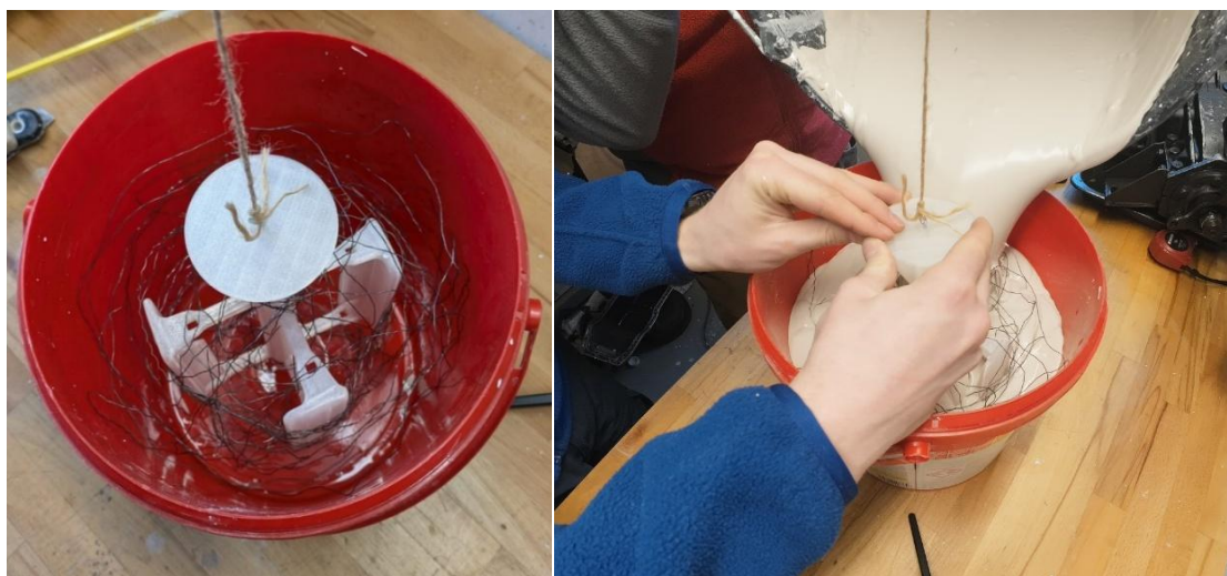
Obr. 23 Stromeček zavěšený ve formovacím rámu a odlévání sádry
