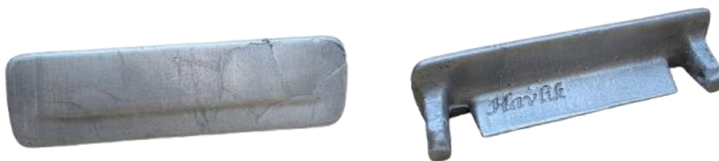
Obr. 37 Finální podoba kliky vyrobené metodou reverzního inženýrství
