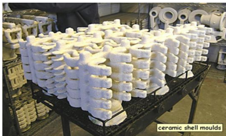
Obr. 13 Hotové keramické formy v sušící místnosti
