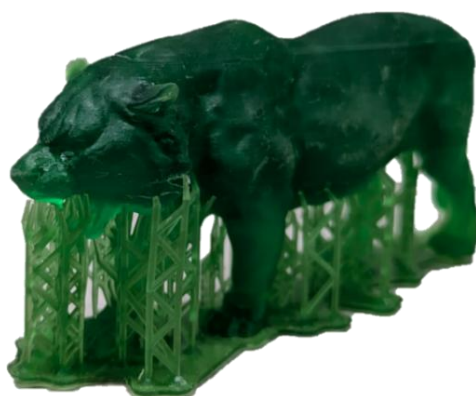
Obr. 11 Model vytištěný na resinové 3D tiskárně
