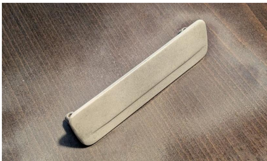
Obr. 14 Klika nastříkaná skenovacím sprejem
