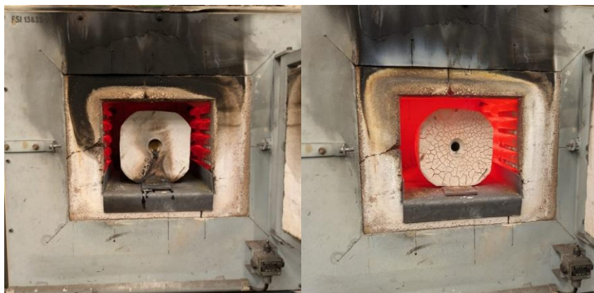
Obr. 26 Forma na začátku vypalování a před vyjmutím z pece 1
